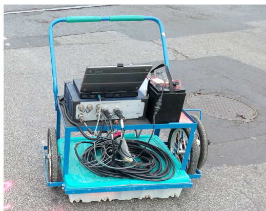
Obr. 2 Georadarový vozík pro měření rychlostí chůze s dipól anténami
