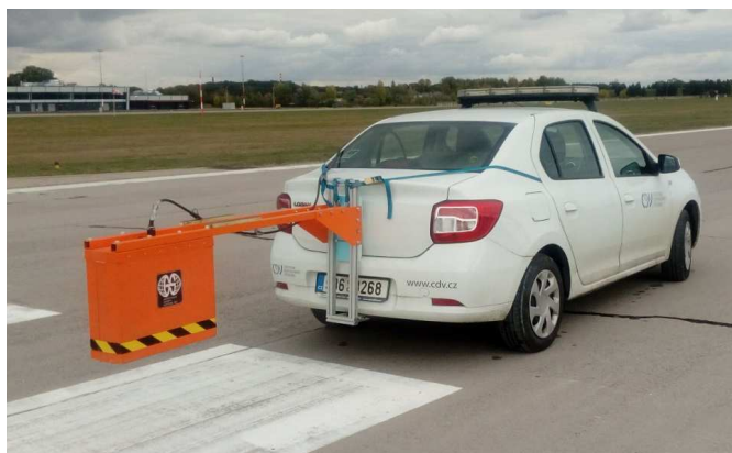
Obr. 1 Měřicí vozidlo s georadarovou anténou typu HORN
