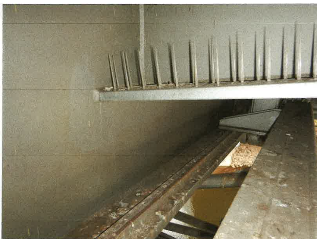
Obr . 16 Znečištěná kolejnice pojezdu vozíku, doporučeno pogumování povrchu
