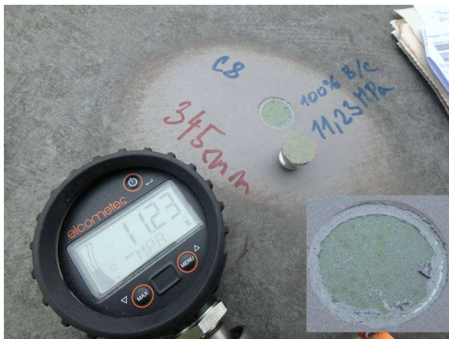
Odtrh C8 provedený na levém pylonu parapetní část vodorovná, prům. tl. 345µm, odtrhová pevnost 11,23 MPa, B/C 100%
