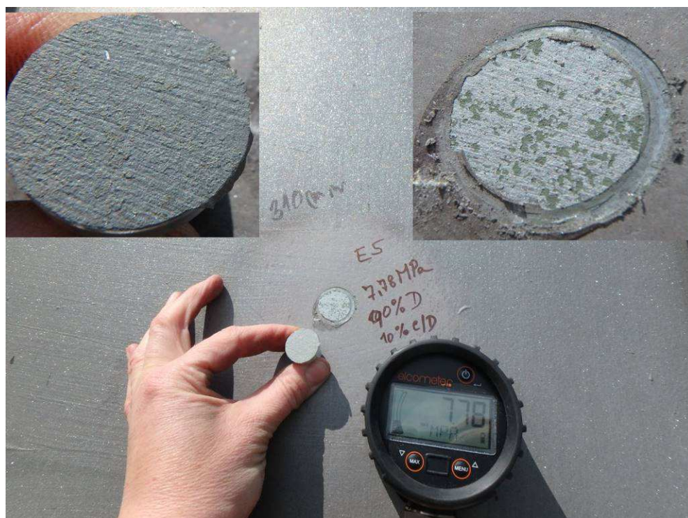
Odtrh E5 provedený na plechu konzoly, prům. tl. 310 \mu m, odtrhová pevnost 7,78 MPa, D 90%, C/D 10%
