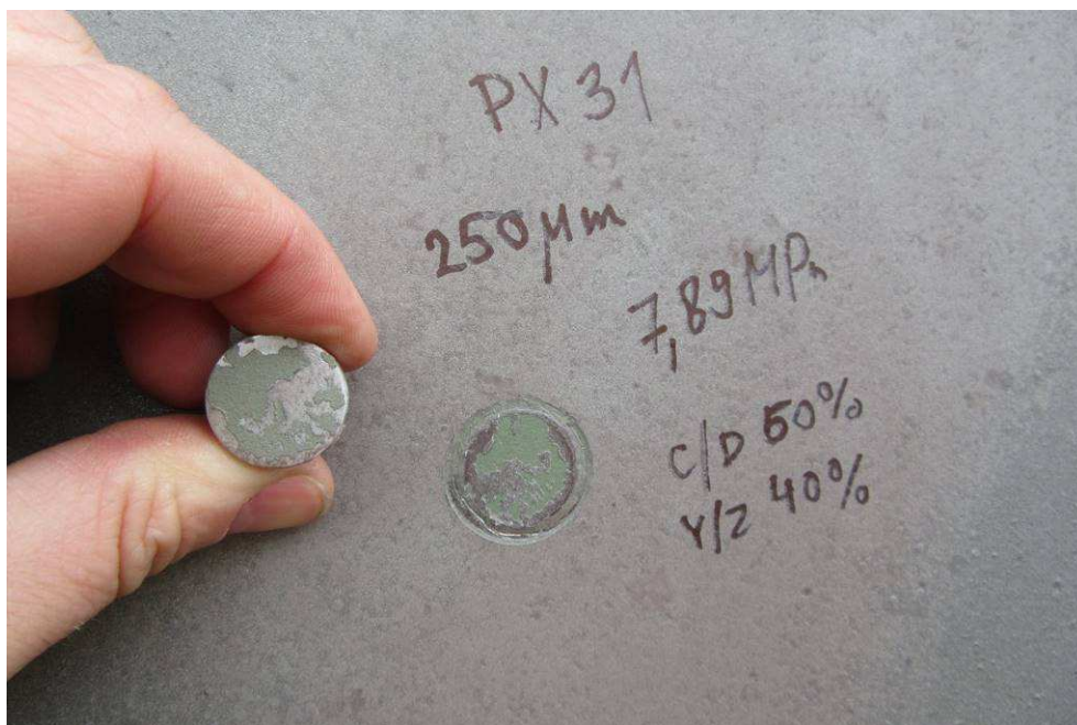
Odtrh PX31 provedený na vnější straně pravého pylonu parapetní část, prům. tl. 250μm, odtrhová pevnost 7,89 MPa, C/D 50%, Y/Z 40%
