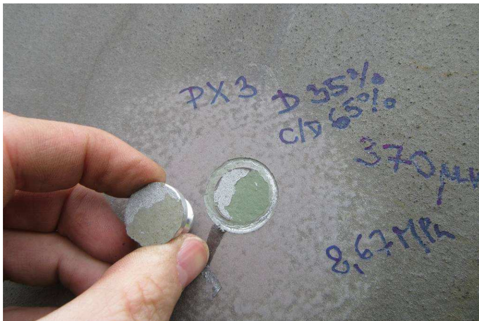
Odtrh PX3 provedený na pravém pylonu boční stěna, prům. tl. 370μm, odtrhová pevnost 8,67 MPa, D 35%, C/D 65%
