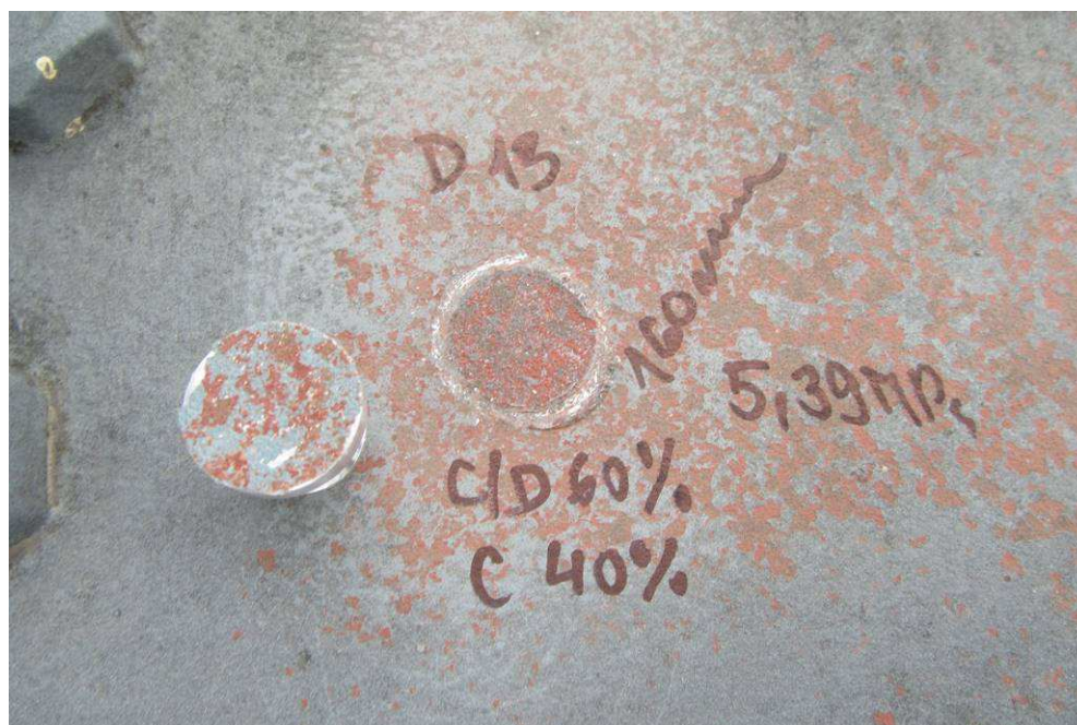
Odtrh D13 provedený na konstrukci svodidla, prům. tl. 160 \mu m, odtrhová pevnost 5,39 MPa, C/D 60%, C 40%
