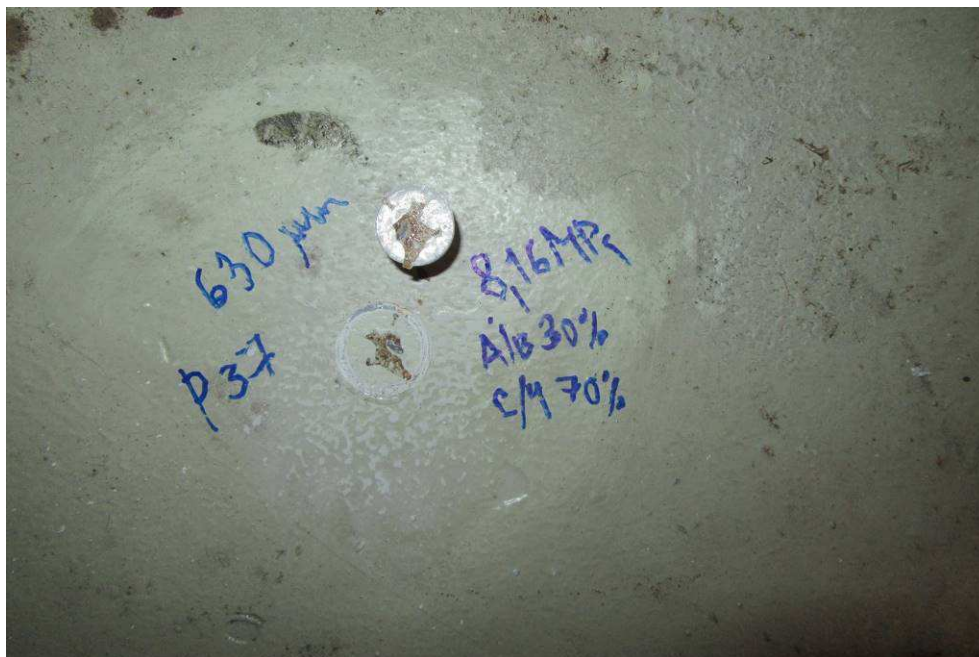
Odtrh P37 provedený na vodorovné výztuze levého pylonu, prům. tl. 630μm, odtrhová pevnost 8,16 MPa, 30% A/B, 70% C/Y
