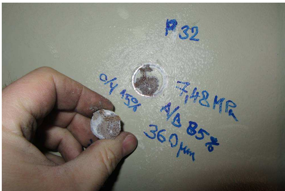
Odtrh P32 provedený ve vrcholu levého pylonu v oblasti montážního svaru, prům. tl. 360µm, odtrhová pevnost 7,48 MPa, 80% A/B (podkorodovaný základní nátěr), 15% C/Y
