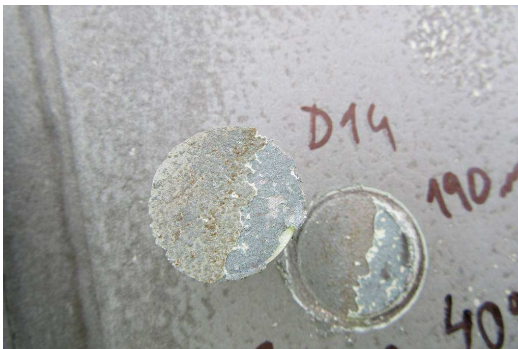
Odtrh D14 provedený na madle zábradelního svodidla, prům. tl. 190 \mu m, odtrhová pevnost 3,03 MPa, D 40%, A/B 60% (částečně podkorodovaný základní nátěr)
