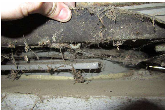
Obr. 309 – Pohled do ložiska po odklopení prachovky
