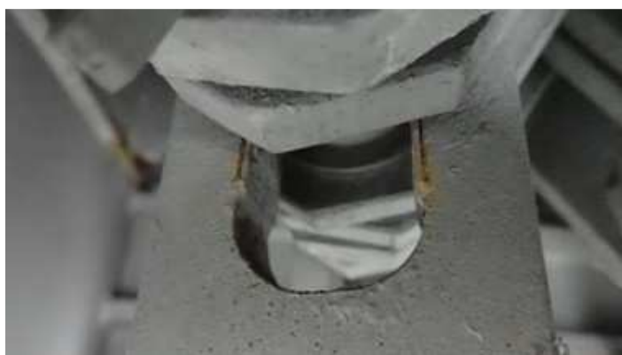
Obr. 299 - Pohled na detail nůžkového mechanismu MZ, drobná koroze
