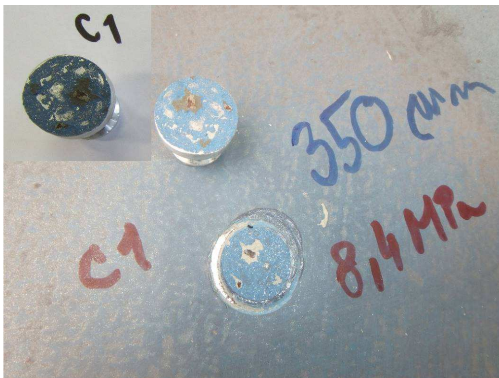
Odtrh C1 provedený na vodorovné ploše křídla, prům. tl. 350 \mu m, odtrhová pevnost 8,40 MPa, A/C 5% (podkorodovaný zákl. nátěr), C 5%, D 90%
