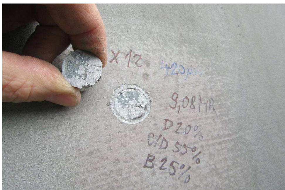
Odtřh LX12 provedený na boční straně levého pylonu nad 5. montážním svarem, prům. tl. 420μm, odtřhová pevnost 9,08 MPa, D 20%, C/D 55%, B 25%
