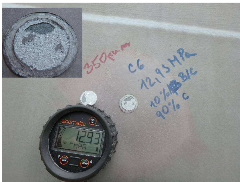
Odtrh C6 provedený na levém pylonu nad vozovkou, prům. tl. 350µm, odtrhová pevnost 12,93 MPa, B/C 10%, C 90%
