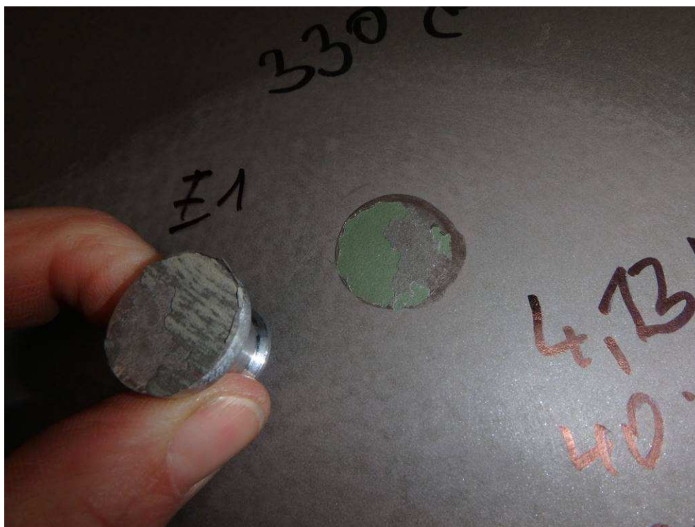
Odtrh E1 provedený na rampě u odvodňovače, prům. tl. 330μm, odtrhová pevnost 4,13 MPa, C/D 60%, Y/Z 40%
