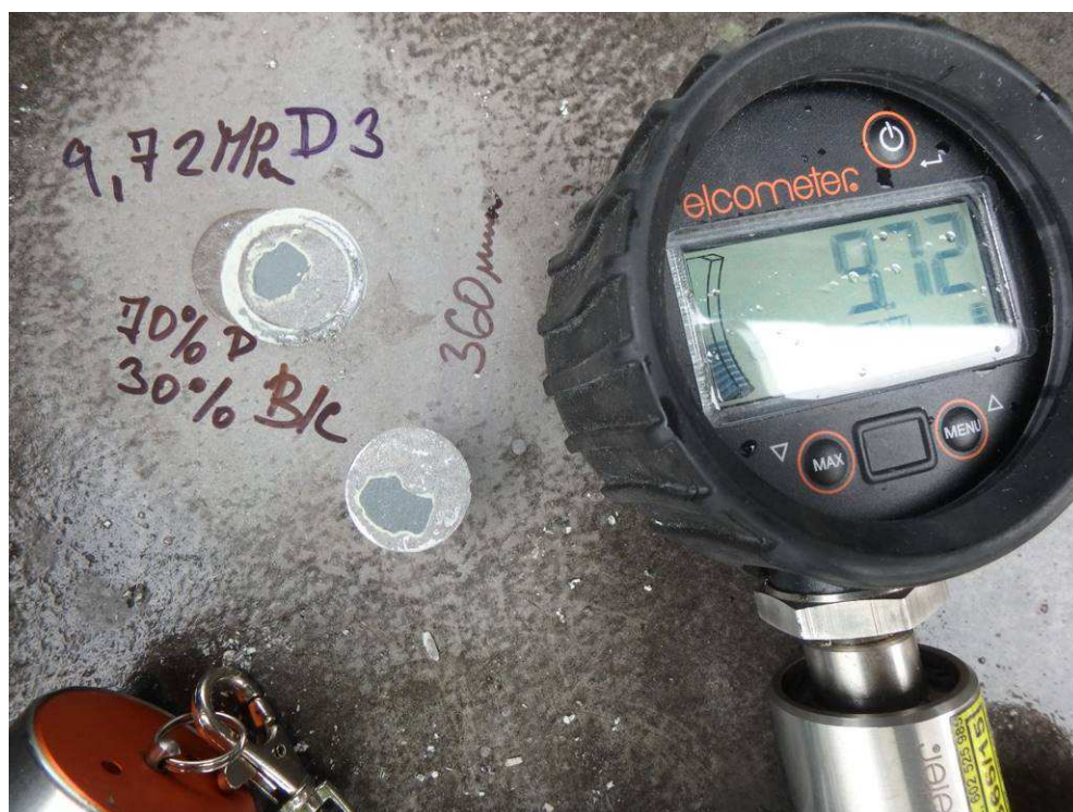
Odtrh D3 provedený na římse vozovky u revizního otvoru, prům. tl. 360µm, odtrhová pevnost 9,72 MPa, D 70%, B/C 30%
