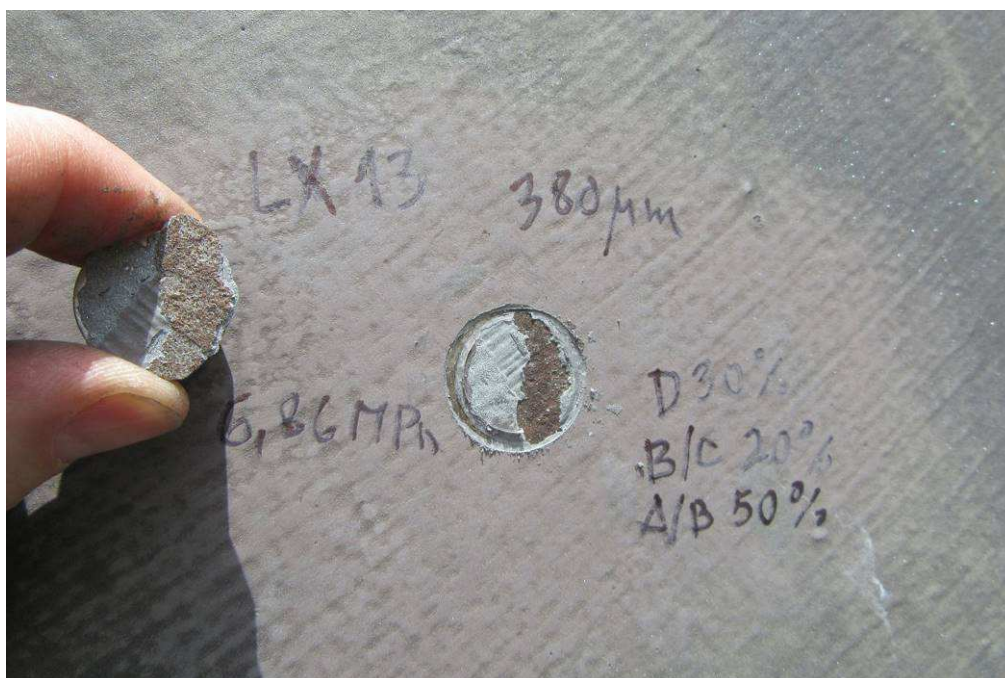
Odtřh LX13 provedený na boční straně levého pylonu nad 8. montážním svarem, prům. tl. 380μm, odtřhová pevnost 6,86 MPa, D 30%, B/C 20%, A/B 50% (podkorodovaný základní nátěr)
