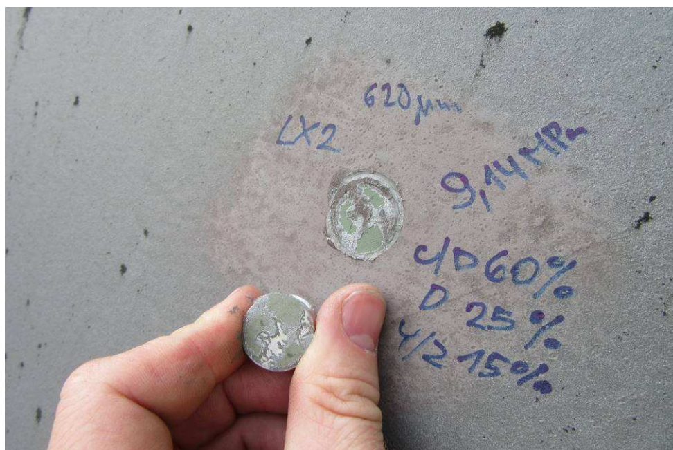
Odtřh LX2 provedený na boční straně levého pylonu směrem k závěsům, prům. tl. 620μm, odtřhová pevnost 9,14 MPa, C/D 60%, D 25%, Y/Z 15%
