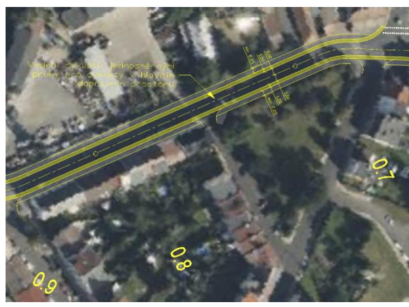
34/ Vedení cyklistů v jízdních pruzích pro cyklisty v hlavním dopravním prostoru na ulici Žižkova
