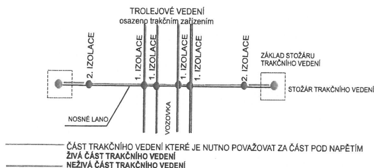
Schematický náčrtek jednoduchého provedení trakčního trolejového vedení
