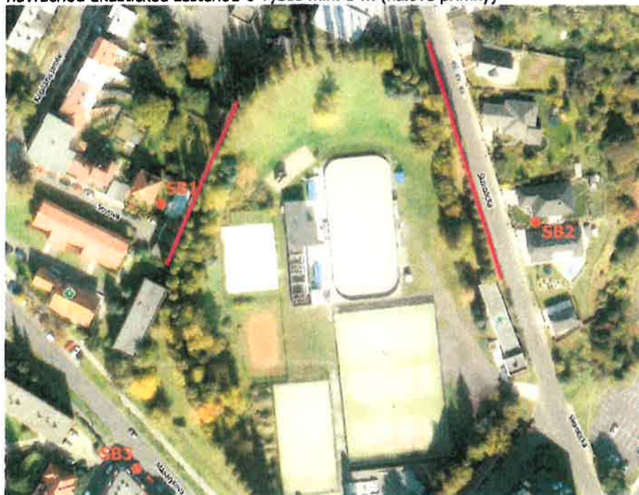
Obr. 1 – hokejbalové hřiště s tribunami (modré objekty), sledovanými body a navrženou akustickou zástěnou o výšce min. 3 m (fialové přímky)
